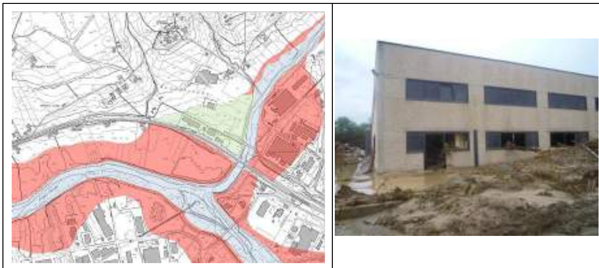
Figura 7.33 – Confluenza tra i fiumi Calore e Tammaro, in prossimità della zona industriale di Ponte Valentino (Zona ASI) nel comune di Benevento; mappa delle aree allagate (in rosso) a seguito dell’evento dell’ottobre 2015 (Fonte: ABD Appennino Meridionale, 2018) e immagine di danni provocati dall’inondazione (Fonte: Autorità di Bacino LGV, 2015).
