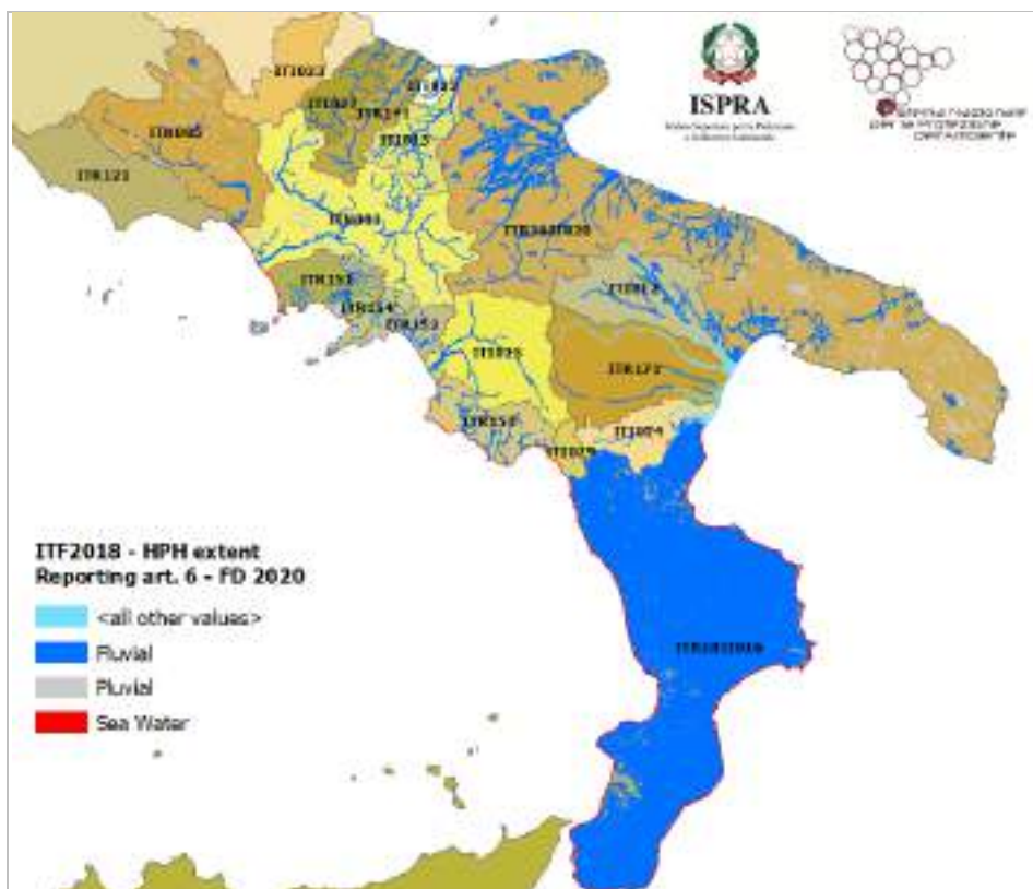
Figura 7.42 – Mappa delle aree allagabili per scenario di probabilità elevata ( High Probability Hazard – HPH) nelle UoM del Distretto Idrografico dell’Appennino Meridionale differenziate per origine dell’alluvione (source = Fluvial; Pluvial; Sea Water; all other values per tutte le altre origini o combinazioni) – Reporting FD 2020.
